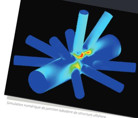
Simulation numérique de jonction tubulaire de structure offshore.
