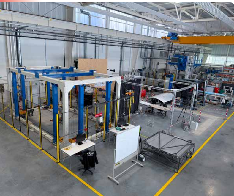
Plateforme de robotique parallèle à câbles pour le projet AMATSUMARA et plateforme robotique XXL du LS2N à l'IRT Jules Verne.
