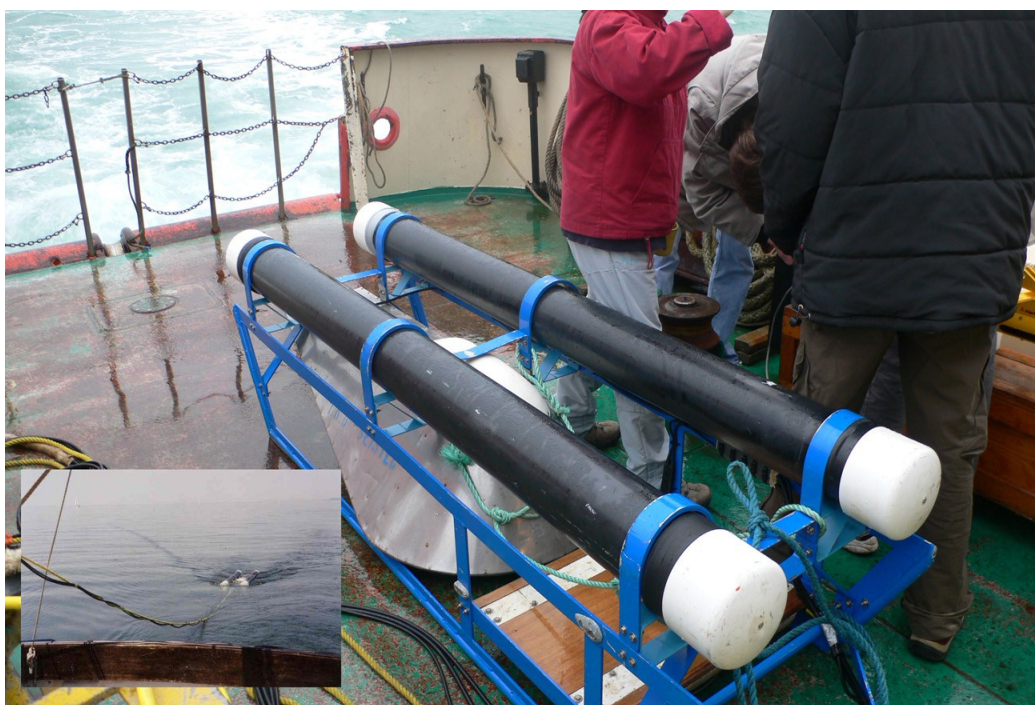
Figure 1. Photograph of the Boomer IKB Seistec aboard the oceanographic vessel « Côte d'Aquitaine » CNRS, normand-breton Gulf, France, 2007.
